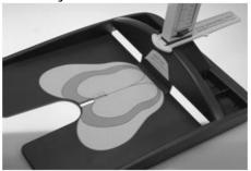
2. Le dos du sujet doit durcir légèrement la tige de mesure de la toise. Descendre le support tête jusqu'à ce qu'il touche le haut de la tête du sujet
