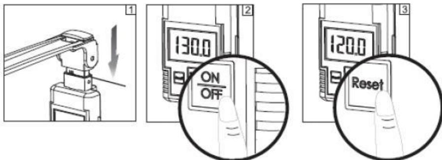
Avant d'allumer le modèle HM200D, positionner la toise complètement baissée. Activez le HM200D à l'aide de la touche **[ON/OFF]**. Le résultat de la mesure de la taille sera automatiquement envoyé à l'indicateur de l'appareil s'il est connecté.
