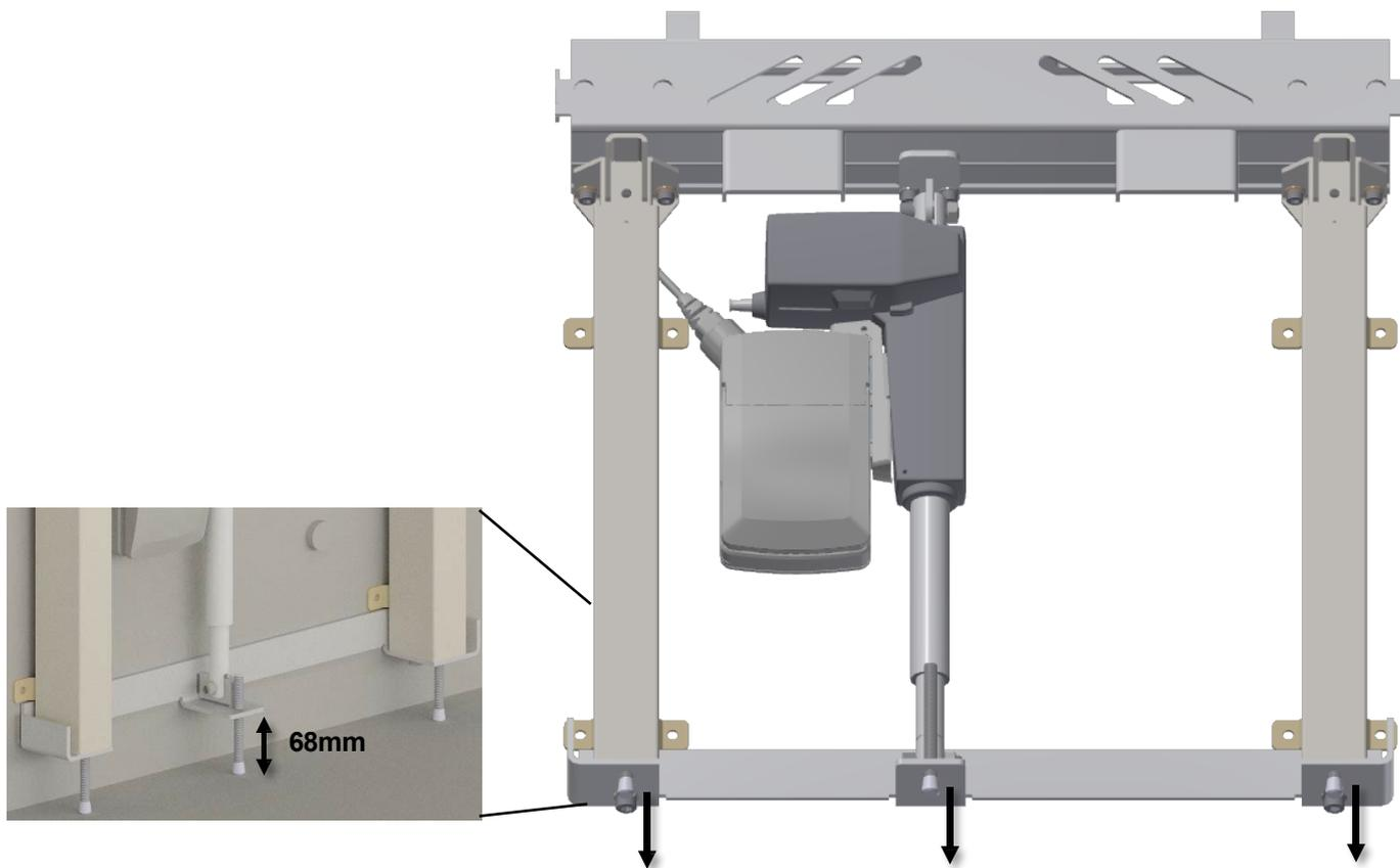
Dévisser les vis de réglage à **68 mm** sous le support.
