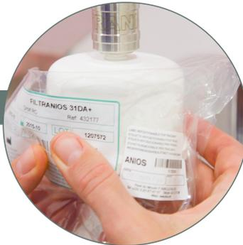
Adapter le filtre sur le raccord rapide et éliminer le sachet.
